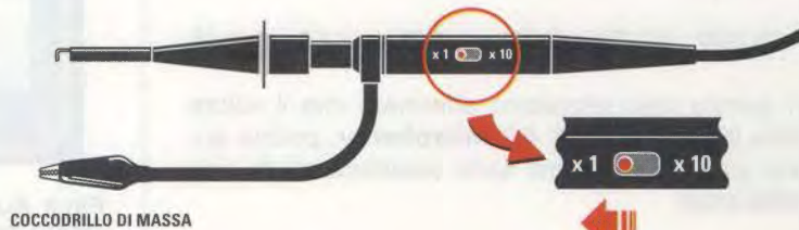
Fig.6 Consigliamo di spostare il piccolo deviatore a levetta posto sul corpo del puntale sonda sulla posizione x1.
