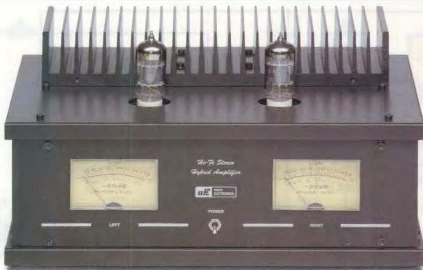
Fig.4 Foto del mobile visto frontalmente. Si notino le due valvole utilizzate per lo stadio d'ingresso e l'aletta a pettine per raffreddare i due Mosfet finali.
